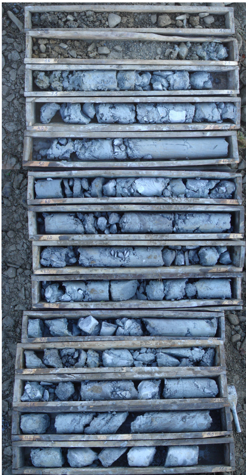
Fot.15 Osuwisko "2" - rdzeń wiertniczy otworu Nr O-5.
