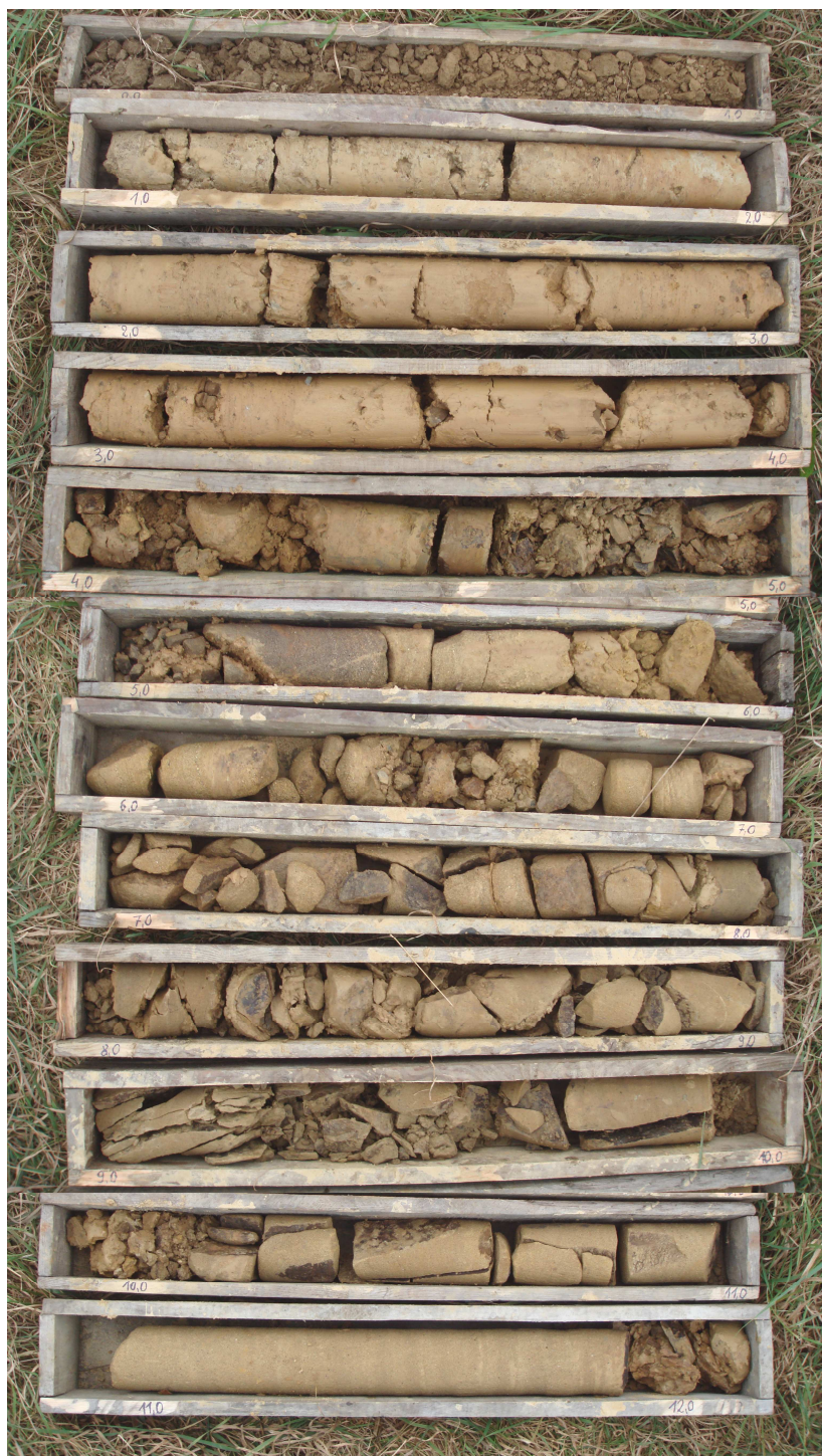
Fot.14 Osuwisko "1" -rdzeń wiertniczy otworu Nr O-3.
