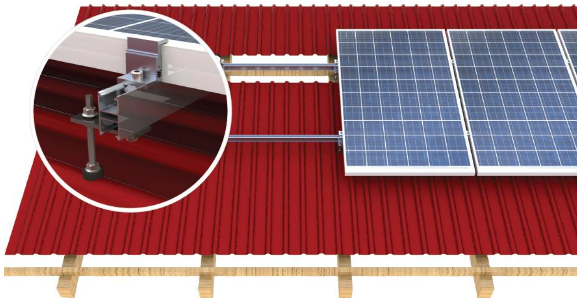
Rys. 8. Ilustracja przykładowego systemu montażowego na blachodachówkę.
