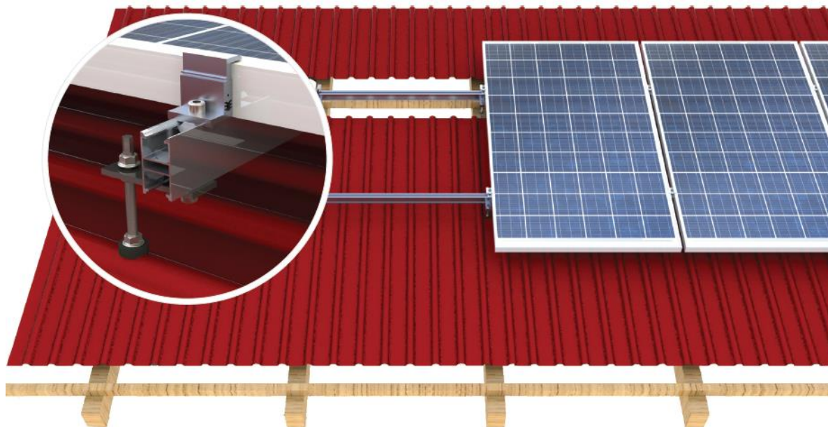
Rys. 6. Ilustracja przykładowego systemu montażowego.
