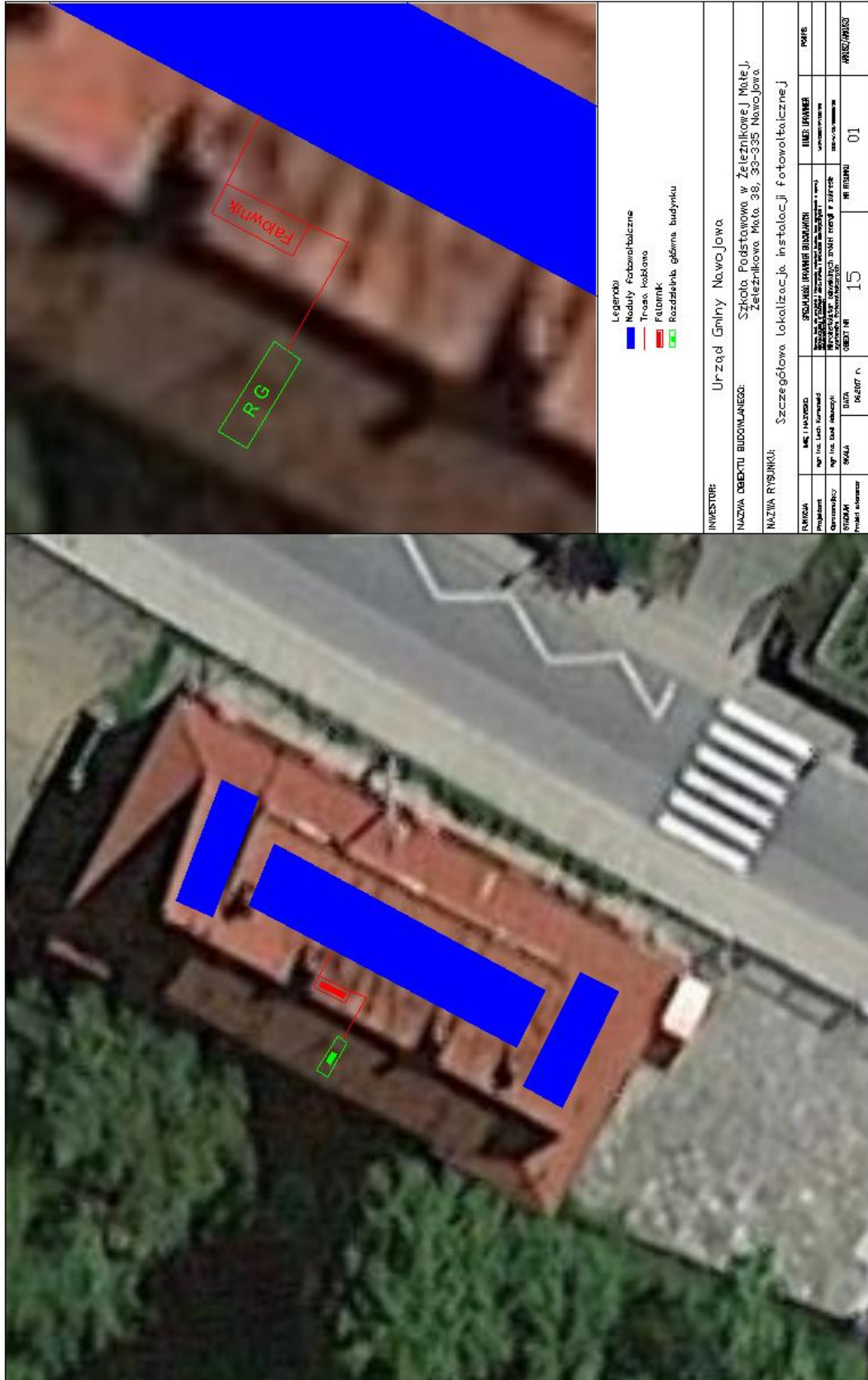
Rys. 6. Lokalizacja instalacji fotowoltaicznej na dachu budynku szkoły w Żeleźnikowej Małej.
